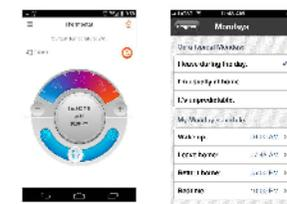
そこで、次世代サーモスタットでは、適切な温度設定とスケジュール運転の2点を中心に改良された。前者は分かりやすいインタフェースでスマホやタブレットでも調整できるようにしている。後者は在宅状況に合わせた暖冷房の運営方法を事前に設定、非在宅時の過剰な暖冷房を防ぐ。
